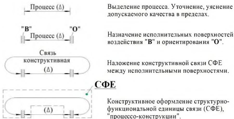
Рис. 5. Схема конструктивного оформления СФЕ связи процессо-конструкции
